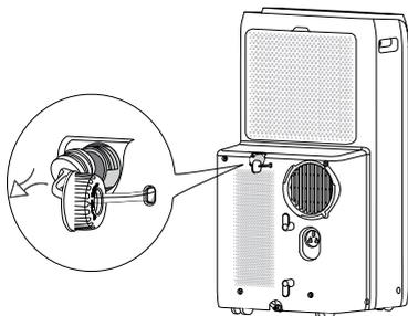
2. Vissez le connecteur de vidange (inclus dans le pack) à l'embout en le tournant dans le sens des aiguilles d'une montre.
