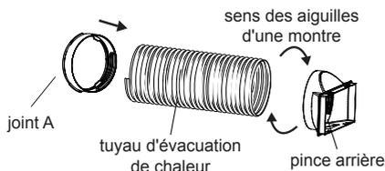
2. Insérez de manière audible le joint A du tuyau d'évacuation de la chaleur dans la rainure.
