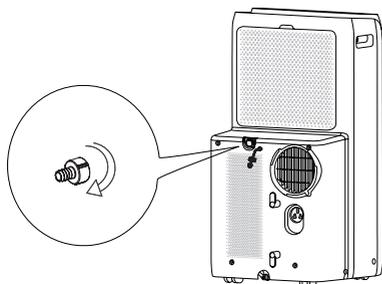
3. Insérez le tuyau de vidange dans le connecteur de vidange.
